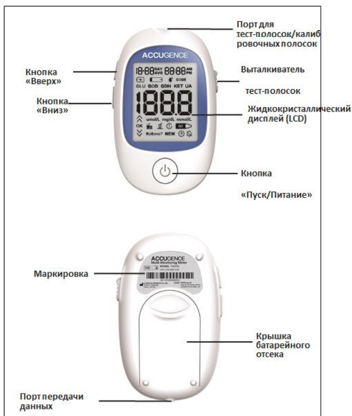
Рисунок 1 – Общий вид анализатора с указанием компонентов
